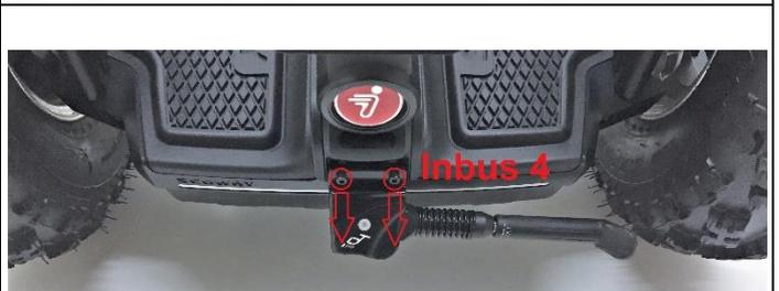
Beim abmontieren des Seg Autostand, welcher am rechten Getriebe montiert ist, bitte **vorsichtig** arbeiten! da dieser erst mit einer Schraube an der Distanzmutter befestigt ist, welche dann wiederum an einer Madenschraube befestigt ist. Die Madenschraube geht durch die Fascia durch. Loctite lösen durch erwärmen z.B. (LötKolben)
