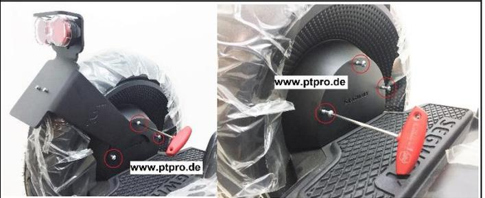
3. Schrauben Sie die Räder ab und entfernen Sie die Räder vom Getriebe
