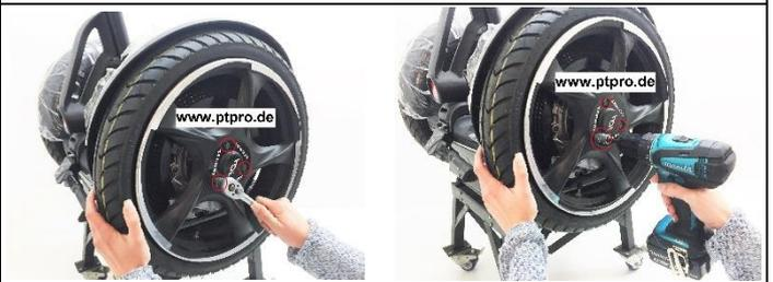
4. Schrauben Sie die Kotflügel (i2 Fender) am Getriebe ab und entfernen Sie die Kotflügel vom Segway PT
