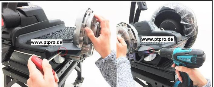
6. Schrauben Sie nun den Parkständer ab. Ist dieser vorne mittig montiert, ist es sehr einfach die zwei Schrauben zu lösen und heraus zu drehen. **Werkzeug: Inbus Nr. 4**
