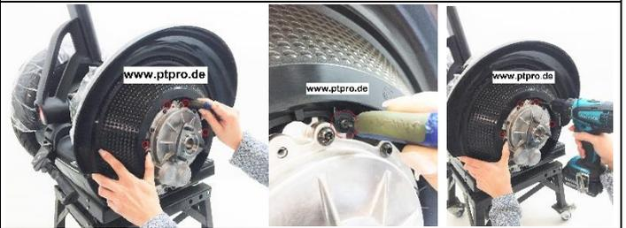
5. Schrauben Sie die Fascia (Verkleidung Stoßstange) vorne und hinten von der Base ab. **Werkzeug: Inbus Nr. 4**
