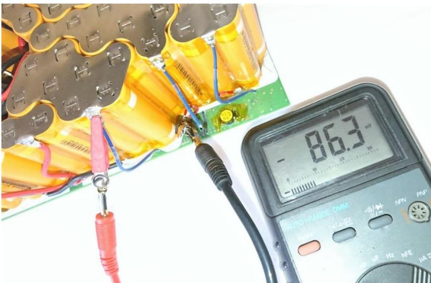
Das BMS Board und die Funktion der Zellen werden überprüft, um sicher zu stellen, dass kein zusätzlicher Defekt am BMS Board vorliegt. Sollten das BMS Board die Daten nicht ordnungsgemäß verarbeiten oder beschädigt sein, so bleibt leider nichts anderes übrig, als dieses zu ersetzen.
