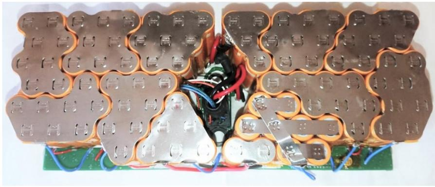
Diese Abbildung zeigt die ausgetauschte Zellengruppe mit dem verbundenen BMS Board vor dem Einbau ins Akkugehäuse
