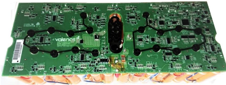
Das BMS Akku Board wird wieder mit den einzelnen Zellengruppen verbunden. Die Lötstellen werden sorgfältig isoliert, um Kurzschlüsse zu vermeiden. Dies bedarf höchster Konzentration und Erfahrung im Akku Reparatur Service. Kalte Lötstellen oder schlecht gelötete Leiter müssen verhindert werden.
