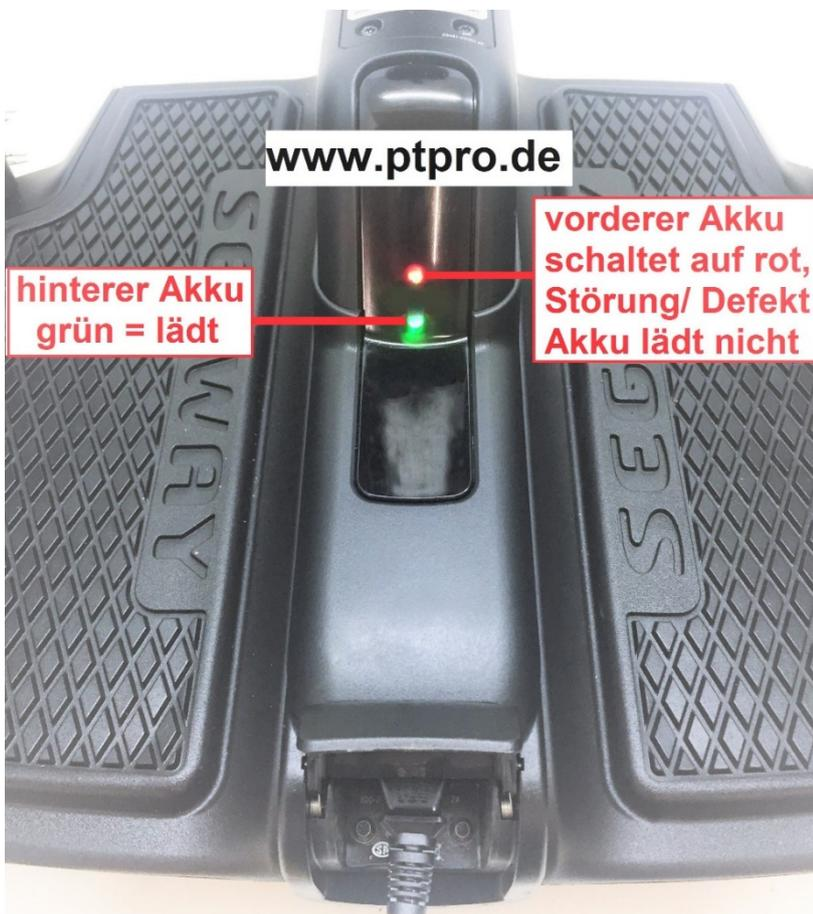
Was tun, wenn auf der Segway PT Konsolenabdeckung eine LED Diode nicht grün sondern rot aufleuchtet, während das Elektrofahrzeug zum Laden am Strom angeschlossen ist.
