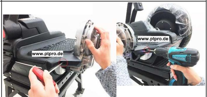
**7. Schrauben Sie die Kotflügel (i2 Fender) am Getriebe an.**
