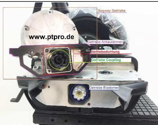
2. Mit einem sehr dünnen Schraubendreher zwischen den Stern und das weiche Elastomer fahren und das Elastomer vorsichtig vom Stern weg drücken.
