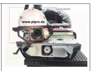
2. Getriebe Anbaurahmen (schwarz) vom Getriebe lösen.
