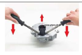
**6.** Ist **das Coupling** weit genug nach oben gehebelt, dann können sie es mit einem kurzen Ruck von Hand **abziehen**.
